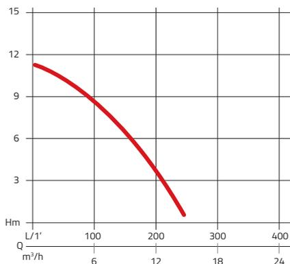
Le diagramme vous montre la capacité de pompage de la pompe submersible FLAT-ROSS de Rössle en m³ par heure par rapport à la hauteur de pompage.
