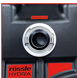
C-Kupplung passend für Feuerweherschläuche
