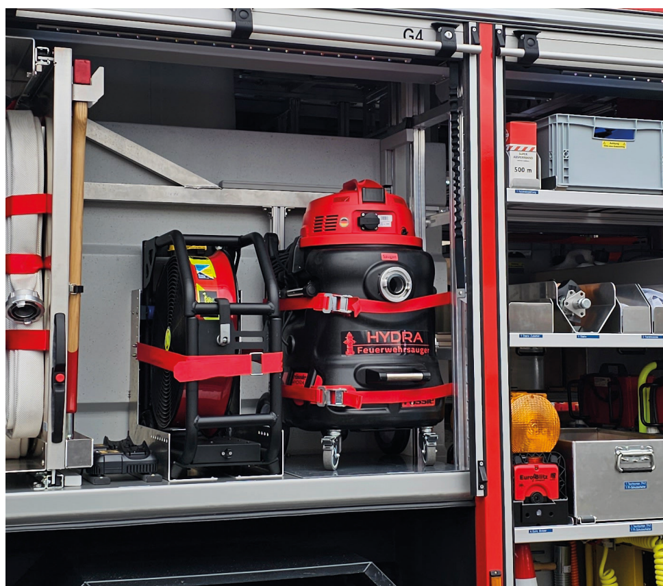
Rückschlagventil RSK und Schmutzwasserpumpe
