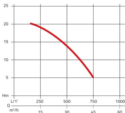
Das Diagramm zeigt Ihnen die Pumpleistung der Rössle Tauchpumpe GIGA in m³ pro Stunde in Relation zur Pumphöhe.
